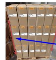
kątownik łączy trzy warstwy kartonów
