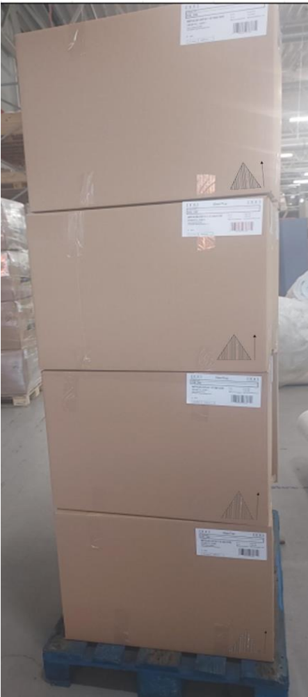
12 kartonów na palecie, kartony ustawione do środka palety - odsunięte od brzegów
