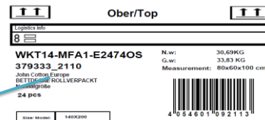
mała napelka z unikatowym kodem kreskowym dla WMS dodawana na paletę(zdjęcie umieszczenia naklejki poglądowe)
